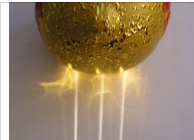
圖 4—三束平行光照射到表面不平滑的豬公撲滿後，向四面八方呈不規則漫射。
