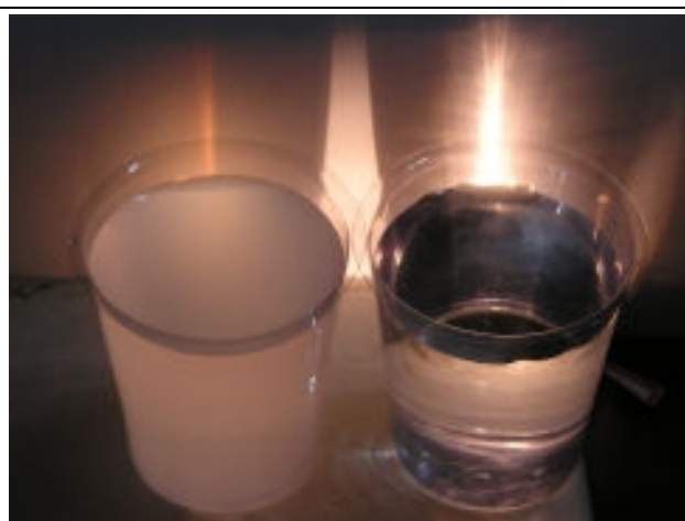
圖 14—於平行光照射下，右邊裝水之杯子前的屏幕所呈現之色光較亮黃，左邊水中加入少許羊奶的杯子所反映出的色光則呈橘黃色。
