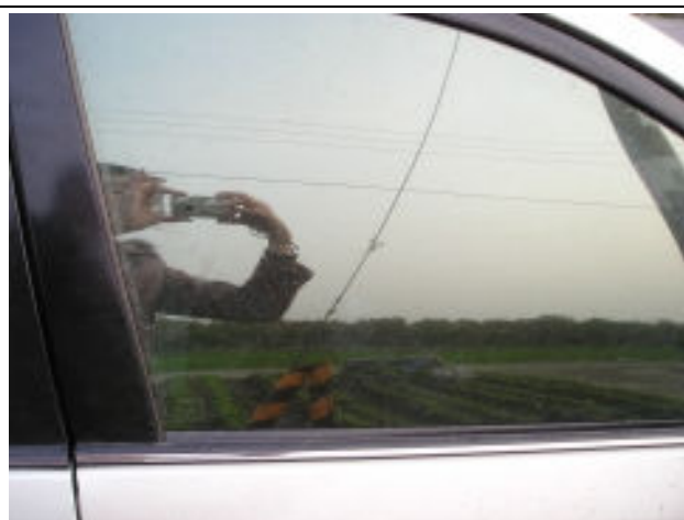
圖 40 一在車外，於貼有隔熱紙的車窗上，可看到外面的影像，看不清裡面的影像。
