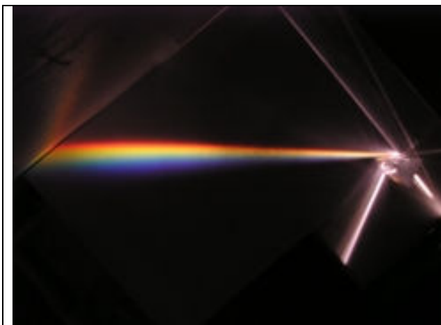
圖 17—光束經三角形柱狀稜鏡折射後產生彩虹之七種顏色。
