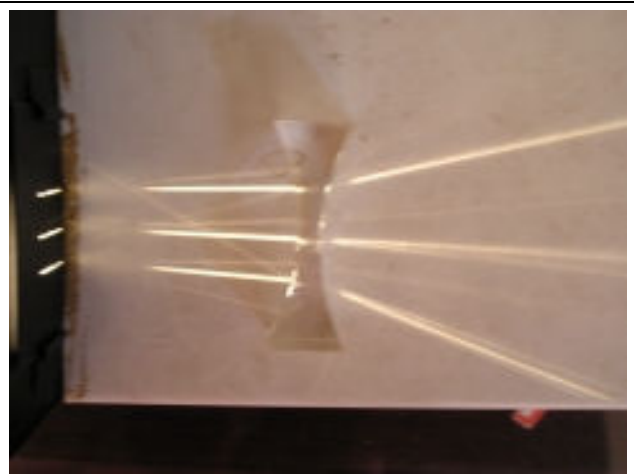
圖 19—平行光經凹透鏡折射後，向四方規則發散出去。
