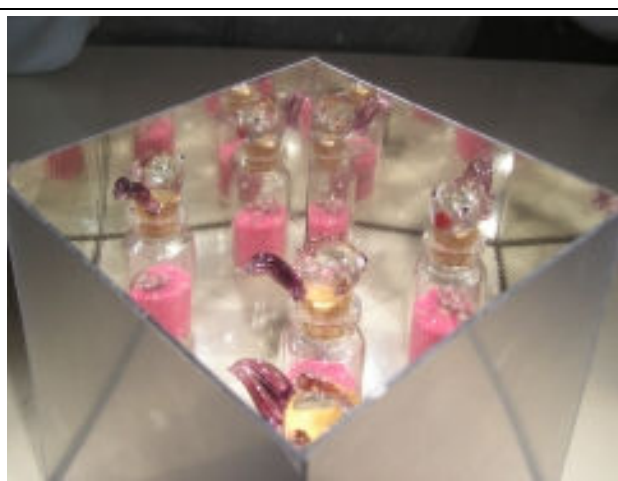
圖 10—三面平面鏡擺放成柱型，物體於其中呈現類似萬花筒中的美麗圖案。
