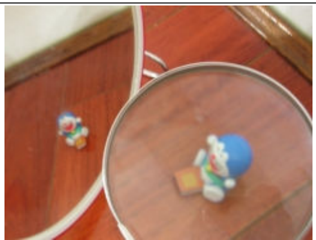
圖 21—光線經凸透鏡折射後，使哆啦 A 夢成正立放大的影像。(透鏡與物體距離較小時)
