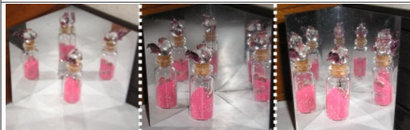
圖 8—兩平面鏡夾角約為 90、60 和 45 度時，物體於鏡中分別呈現“三個影像”、五個影像”和“七個影像”。
