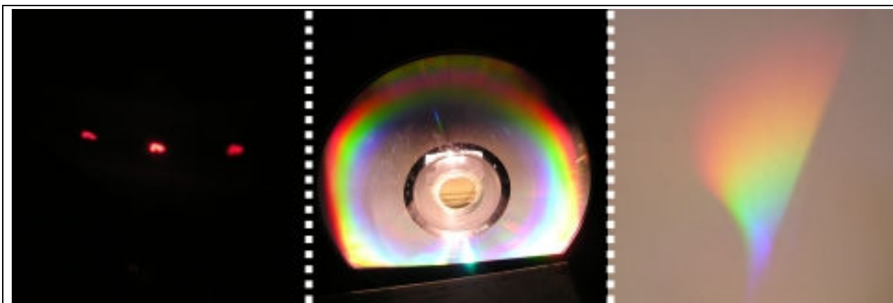
圖 46 一圖中分別顯示“紅色雷射光照射 VCD 片所產生之狹縫干涉現象”、VCD 於光照下所顯現的彩色環”和“VCD 於光照下，光影反射至屏幕的情形”。
