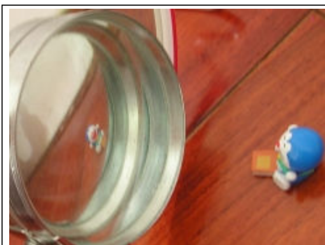
圖 31—凹透鏡置於平面鏡上，凹透鏡上哆啦 A 夢之影像呈正立縮小。
