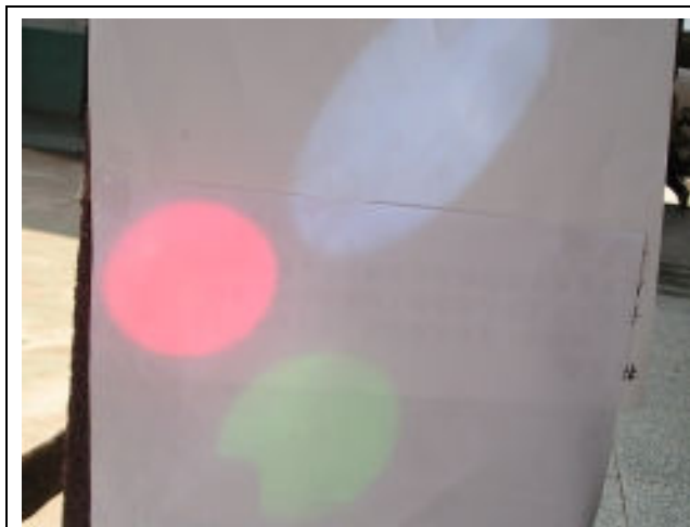
圖 11—太陽光經貼有紅、綠、藍玻璃紙的三面平面鏡反射後，分別出現紅、綠、藍三種色光。
