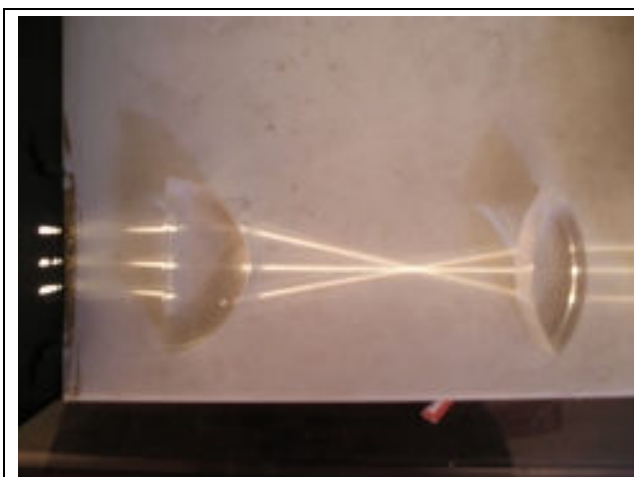
圖 29—平行光經相隔適當距離之兩凸透鏡折射後，成平行光折射出去。
