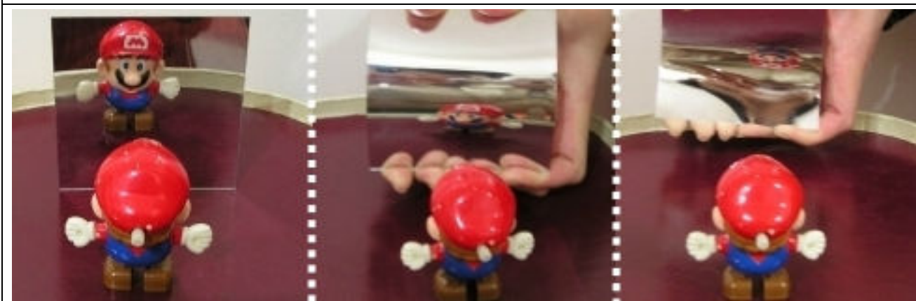
圖 7—瑪利置於平面鏡、凸面鏡和凹面鏡前方所形成的成像和原物比較起來，分別為“左右相反，比例不變”，正立縮小”和“倒立縮小”。
