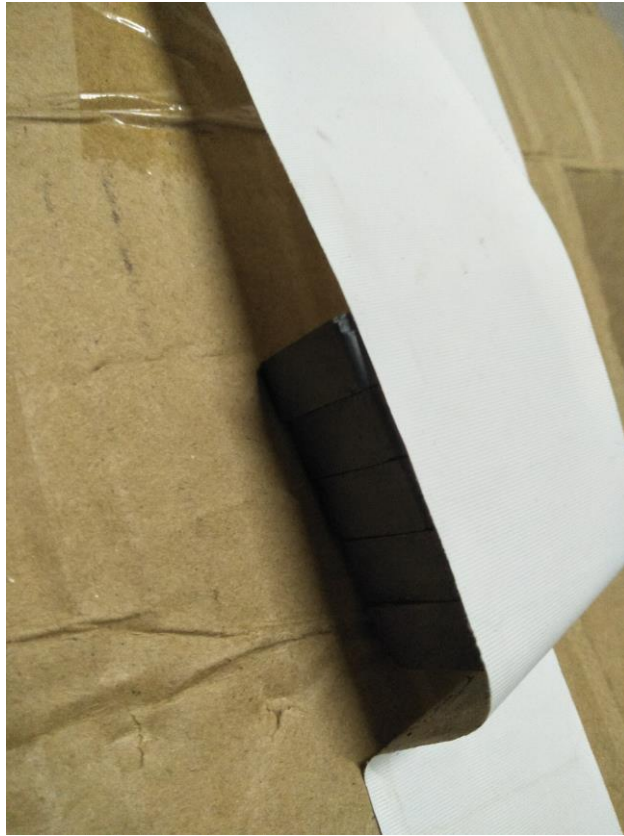
利用磁鐵將鐵罐及鋁罐分類
