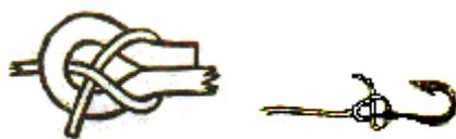
適合用於連接兩條粗細及材質不同的繩索。它牢固、易打是一個可靠的結。不過在大拉力下，接繩結易被夾擠，這是它唯一的缺點。如果兩繩的粗細差異甚大，則建議使用重接繩結。由於接繩結是接繩中極方便的結，所以應用非常廣，也擁有了許多的名稱：編織結、紡織結 <Weaver's knot>、紡織接結 <Weaver's bend>、單接結 <Single bend>、平凡接結 <Common bend>.....等。
