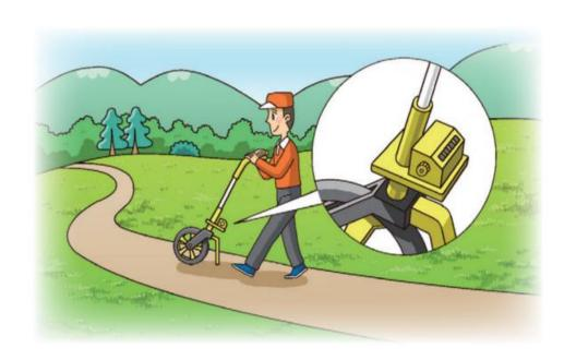
測距輪就是利用圓形輪子的 旋轉圈數,來計算距離的一 種測量工具。
