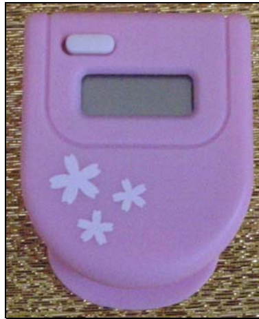
圖 3-2 電子計步器(MATSUI)，型號為「FTM02」
