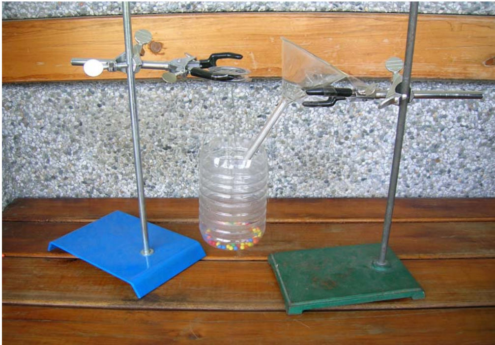
圖 1-5：磁鐵上下方各吸引一鐵片，下方鐵片吊掛一塑膠瓶。瓶中所置入的 BB 彈重，即代表該磁鐵吸力大小。
